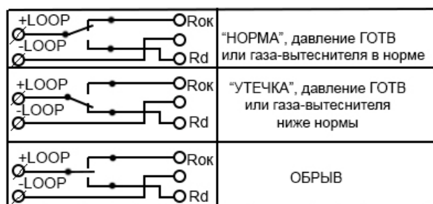
Рис 24.4 Схема переключения контактов реле УКД в шлейфе контроля давления
