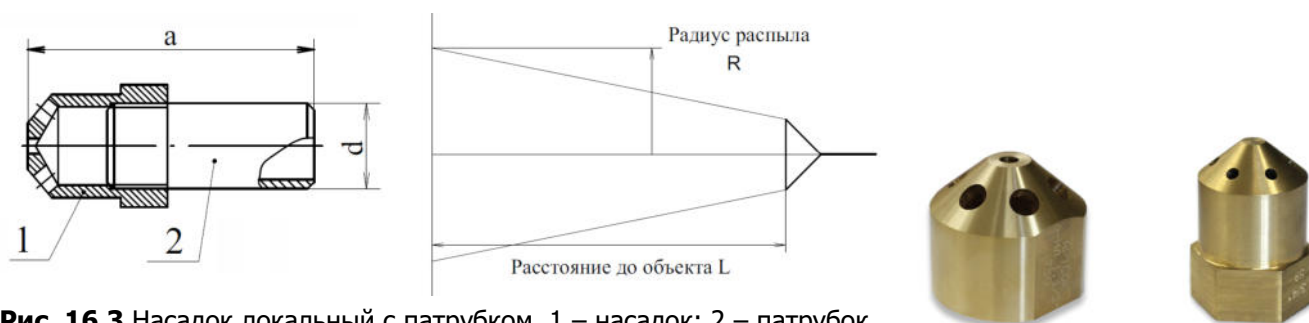
Рис. 16.3 Насадок локальный с патрубком. 1 – насадок; 2 – патрубок.
