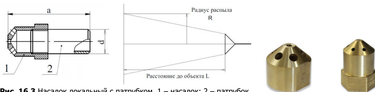
Рис. 16.3 Насадок локальный с патрубком. 1 – насадок; 2 – патрубок.
