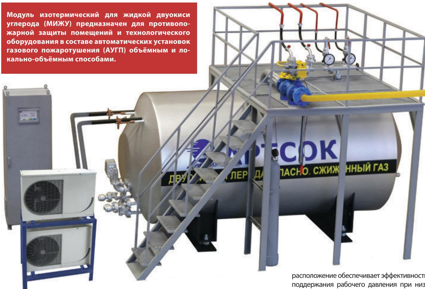
Целью создания модулей изотермических для жидкой двуокиси углерода типа МИЖУ явилось снижение стоимости защиты установками газового пожаротушения помещений объемом свыше 1000 м<sup>3</sup>, для которых применение модулей газового пожаротушения высокого давления типа МГП становится слишком затратным.
