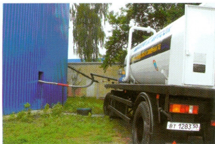
Рис. 1 Установка МИЖУ-5/2,2-АП с гибким магистральным трубопроводом
